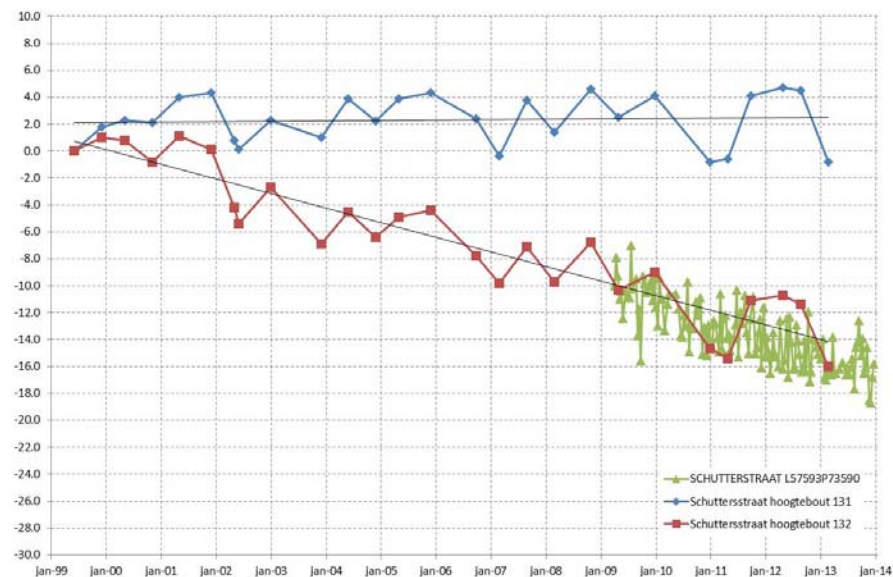
Figuur 5-5 Hoogtebout 131 in de Schutterstraat is niet gezakt. Deze bout is gemonteerd aan het portaal van een onderheid gebouw naast het Lumentheater. Terwijl hoogtebout 132 is gemonteerd in een tegenover dit gebouw gelegen op staal gefundeerde keermuur. Deze hoogtebout is 1.1 mm per jaar gezakt.
