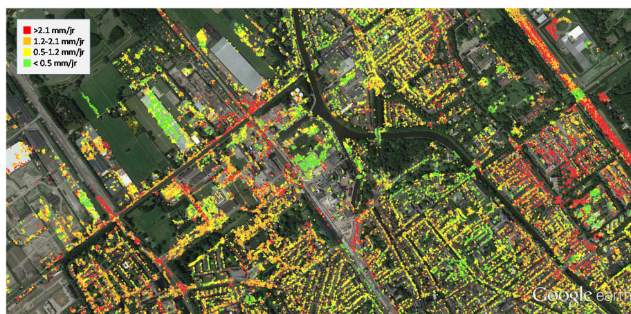
Figuur 5-1. Bodemdaling rond de onttrekking in Delft-Noord. Naast de bodemdaling rond de spoortunnel valt ook de bodemdaling rond de Koepoortgarage en de A13 op
